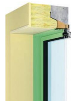
Isolation thermique par l'extérieur (ITE)
